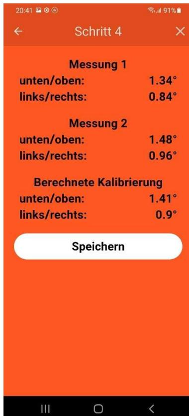
Hier werden Ihnen die Ergebnisse der Messung 1 und Messung 2 angezeigt. Die berechnete Kalibrierung ergibt sich aus dem Durchschnitt der Messung 1 und der Messung 2.
