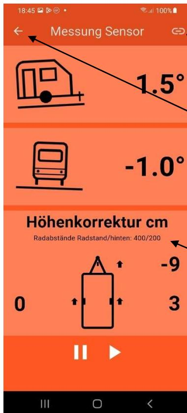
Im oberen Teil wird die Neigung des Fahrzeugs von hinten nach vorne und die Neigung von links nach rechts im Gradmaß im Intervall [-30° - +30°] angezeigt.
