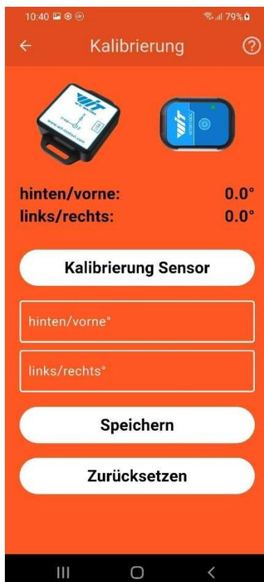
In Level plus kann der Sensor automatisch und manuell kalibriert werden. Soll der Sensor auf einer nicht waagerechten Ebene im Fahrzeug (max.  $\pm 30^\circ$ ) montiert werden, dann kann der Sensor so kalibriert werden, dass diese Ebene als waagerecht für den Sensor gilt.
