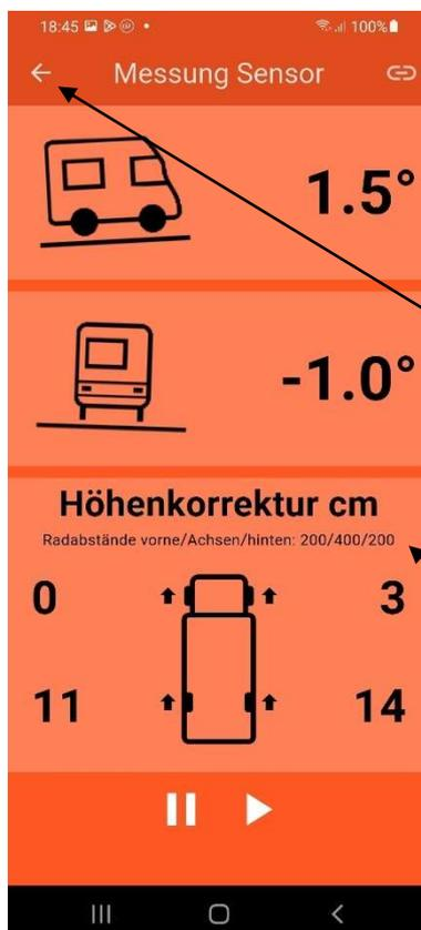
Im oberen Teil wird die Neigung des Fahrzeugs von hinten nach vorne und die Neigung von links nach rechts im Gradmaß und im Intervall [-30° - +30°] angezeigt.
