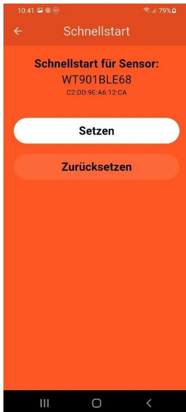
Damit Sie nach Montage, Verbinden und Kalibrierung des Sensors in dem Fahrzeug nach dem Start der Level-App sofort die Seite mit der Messung des Sensors angezeigt bekommen, können Sie den Schnellstart für den verbundenen Sensor einrichten.
